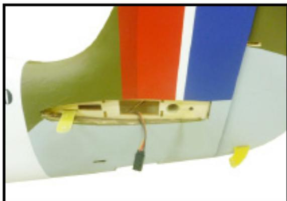
**INSTALLING THE HORIZONTAL STABILIZER.**
