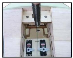
RUDDER PUSHROD INSTALLATION
