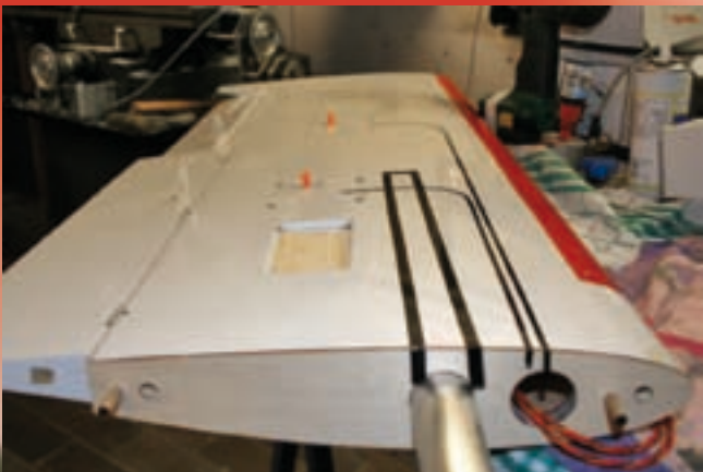
Das Einziehen der Servokabel gestaltet sich zur Geduldssprobe – hier ist der Kabelverlauf auf der Fläche markiert.
