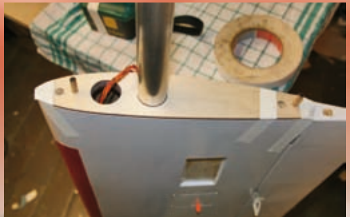
Zum Bohren der Flächensicherungsbolzen liegt eine Schablone bei.
